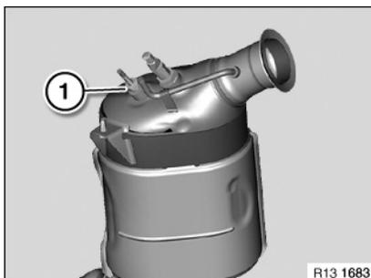
Détacher et déposer le capteur de température des gaz d'échappement.
