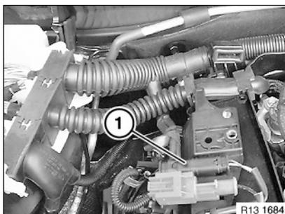
Débrancher le connecteur (1) du capteur de contre-pression d'échappement.
